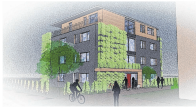
Begrünte Fassaden sollen in den Mehrfamilienhäusern ein angenehmes Klima schaffen.
